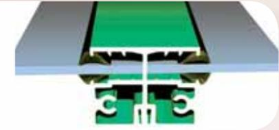
Die Materialien der Verglasungen bei der Schwimmbadüberdachungen sind zwischen ein- oder zweiseitige Gummidichtungen wegen Wärmedämmung und Flexibilität eingebaut.
